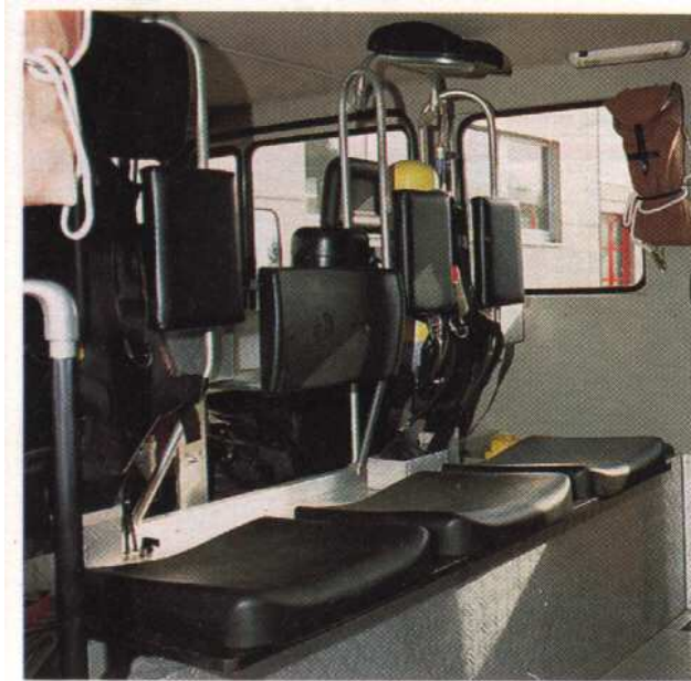
Slika 2.2. Vgrajeni izolacijski dihalni aparati v prostoru za enoto
