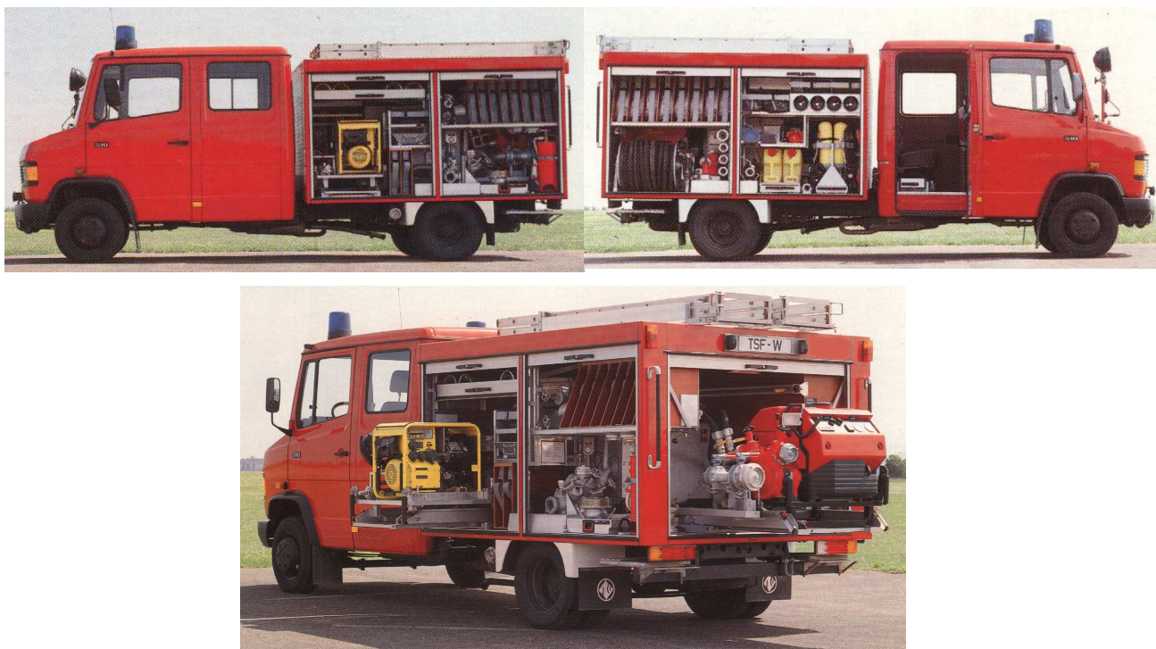
Slika 4.8, 4.9 in 4.10: Manjše gasilno vozilo z vodo GVV-1 1+5
